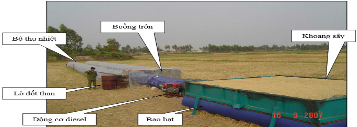
Hình 5. Máy sấy lúa SRA-4B, năng suất 4 tấn/m 2 [Phan Hiếu Hiền], luồng khí sấy đi từ dưới lên.
